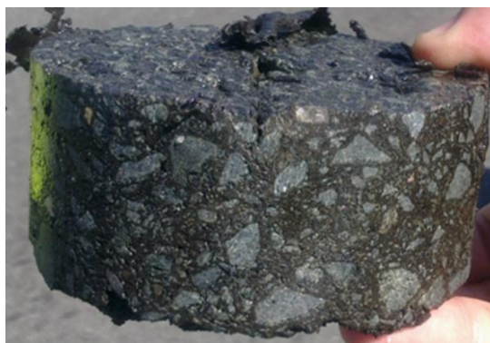
Рис. 3. Керн, отобранный в месте сопряжения смежных полос покрытия
