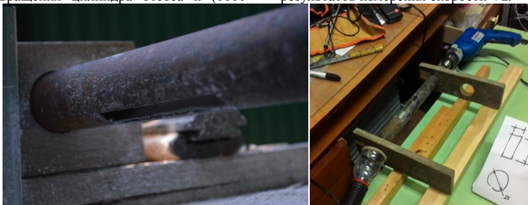
Рис. 1. Исследовательский стенд вращающегося цилиндра-отсоса
