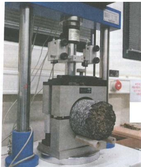
Рис. 1. Испытание керн из асфальтобетонного покрытия на сопротивление сдвигу по стандарту DIN
